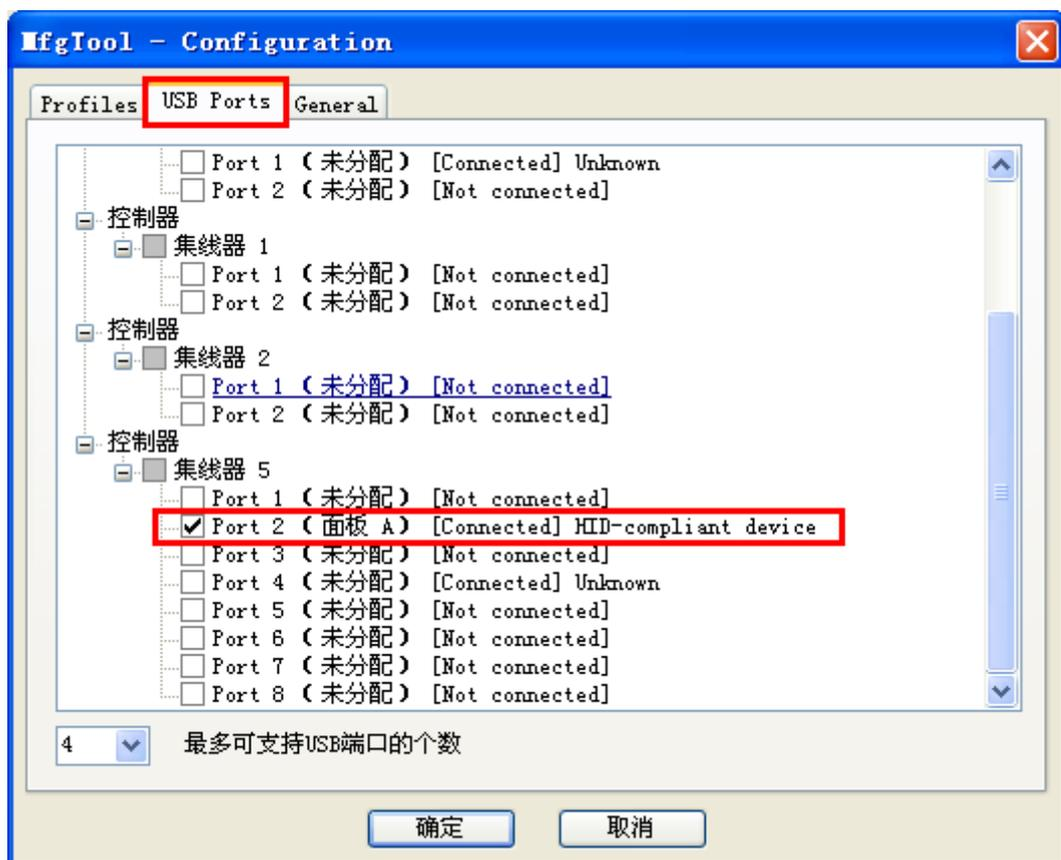
2、在该程序界面中显示有“HID-compliant device”字样后，点击“开始”按钮进行烧写。
