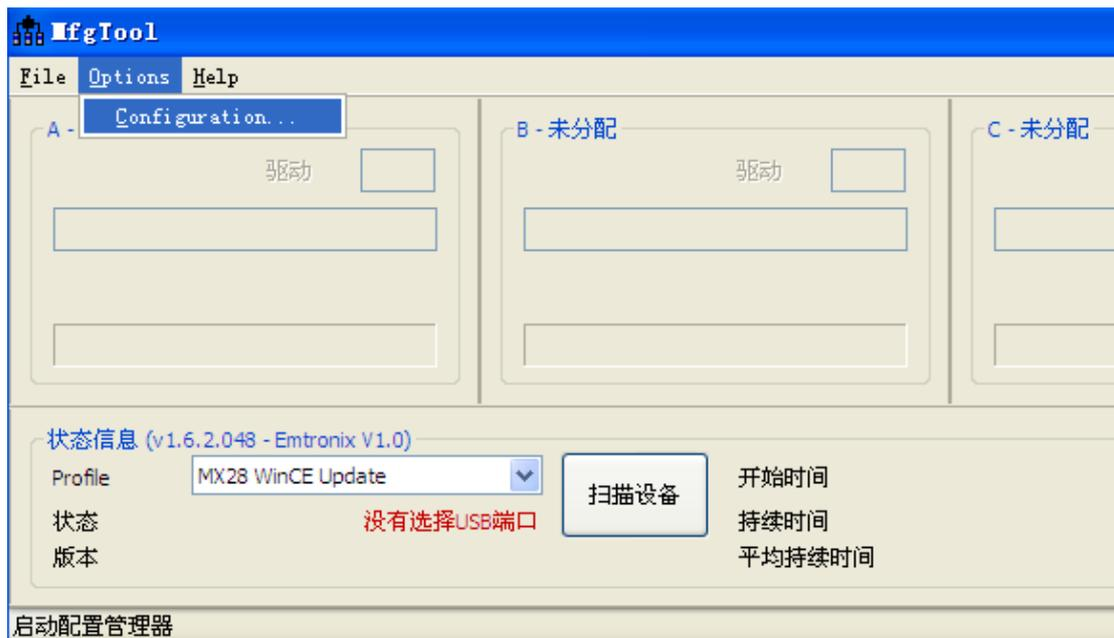
选择 USB Ports 页，选中设备所在 USB 口（可以通过反复插拔 USB 线，确定设备所在 USB 口）。
