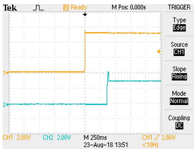
ESM7000 主板上电时 RESET_IN_OUTn 时序 (CH1: 5V 电源, CH2: RESET_IN_OUTn 信号)
