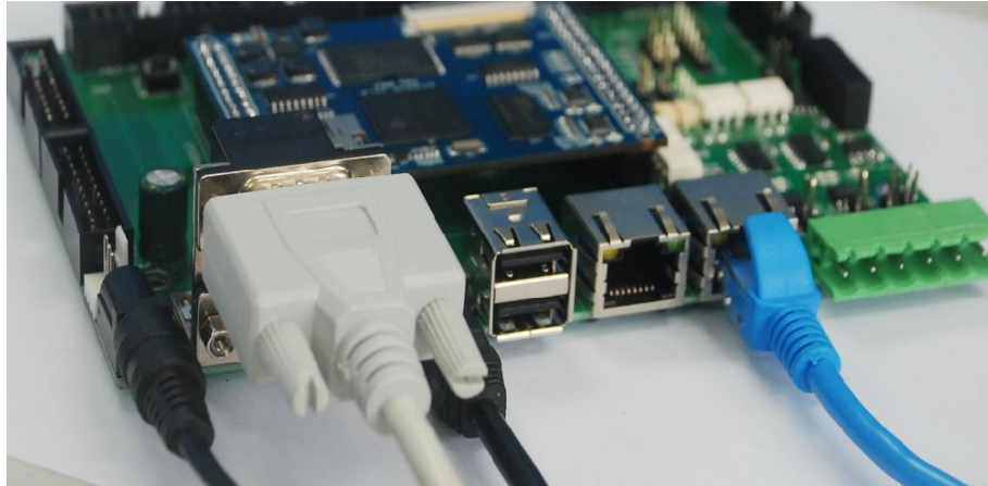
图 2_6: 连接电源适配器, 给系统上电
